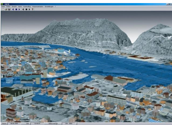
3D-Visualisierung einer numerischen Hochwassersimulation am Neckar
